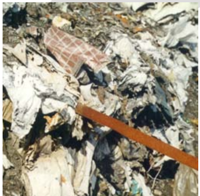
Nedokonale spálený odpad, ktorý prešiel kotlom spaľovne komunálnych odpadov
